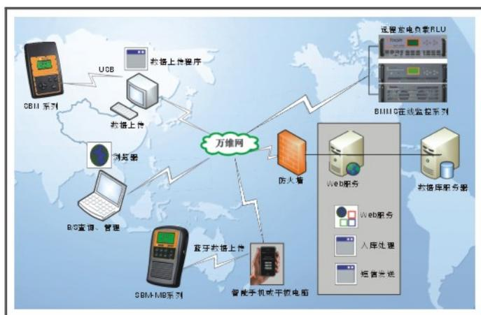
采用Microsoft SQL数据库，依据数据的不断扩展，能简便升级数据库库容，确保数据库可靠维护和系统运行效率。数据记录电池组的组成信息、单体电池的型号参数信息、位置信息、运行信息、性能及告警信息。
